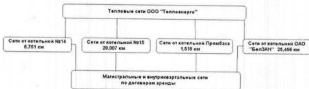
Рисунок 1.6 - Структура тепловых сетей ООО «Теплоэнерго»
